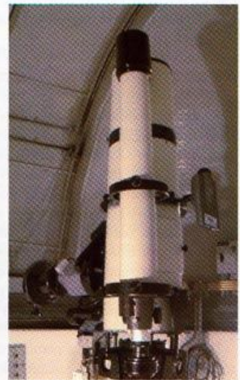
In alto (Fig. 4). Il telescopio tedesco del progetto BEST è uno strumento di media qualità anche secondo gli standard qualitativi amatoriali. La combinazione ottica è quella Schmidt, 20 cm, f/2,7 con CCD 2048x2048, campo: 3,1°x3,1°.
