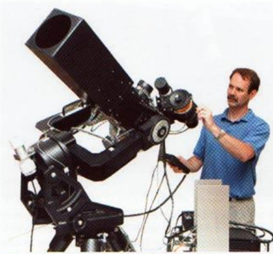
In alto (Fig. 2). Timothy Brown, uno dei responsabili del progetto TrES , effettua delle regolazioni al telescopio STARE . Lo strumento di 10 cm di diametro è supportato da una montatura equatoriale Meade LX 200 e dispone di un CCD di 2034 x 2034 pixel. Le riprese per la ricerca degli esopianeti sono effettuate in genere con due minuti di esposizione.
