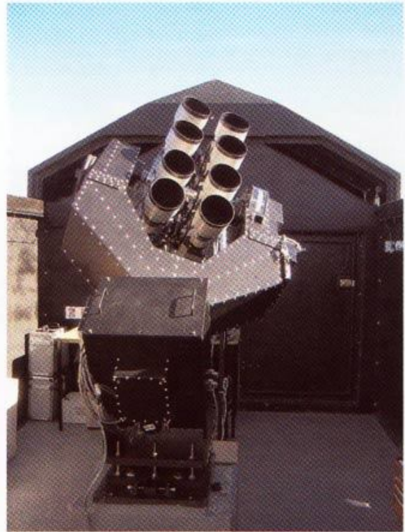
In alto (Fig. 5). Il superWASP è uno dei progetti di ricerca strumentalmente più sofisticati tra quelli oggi attivi. I due telescopi in dotazione dispongono di 8 teleobiettivi Canon di 11 cm di diametro e di CCD della Andor di Belfast (uno dei migliori produttori europei di camere digitali professionali).
