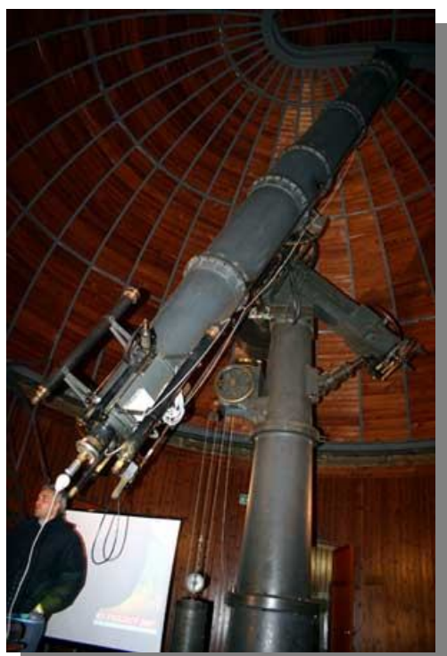
Il grande rifrattore di 40cm dell'Osservatorio INAF di Collurania; a sinistra nell'immagine, il Dott. Mauro Dolci.
