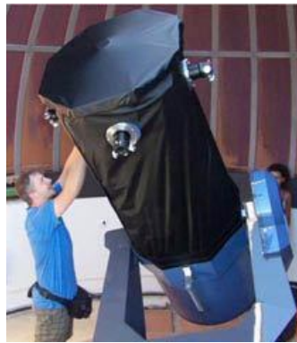
Il riflettore Reginato di 60cm di Diametro, f/3.6
